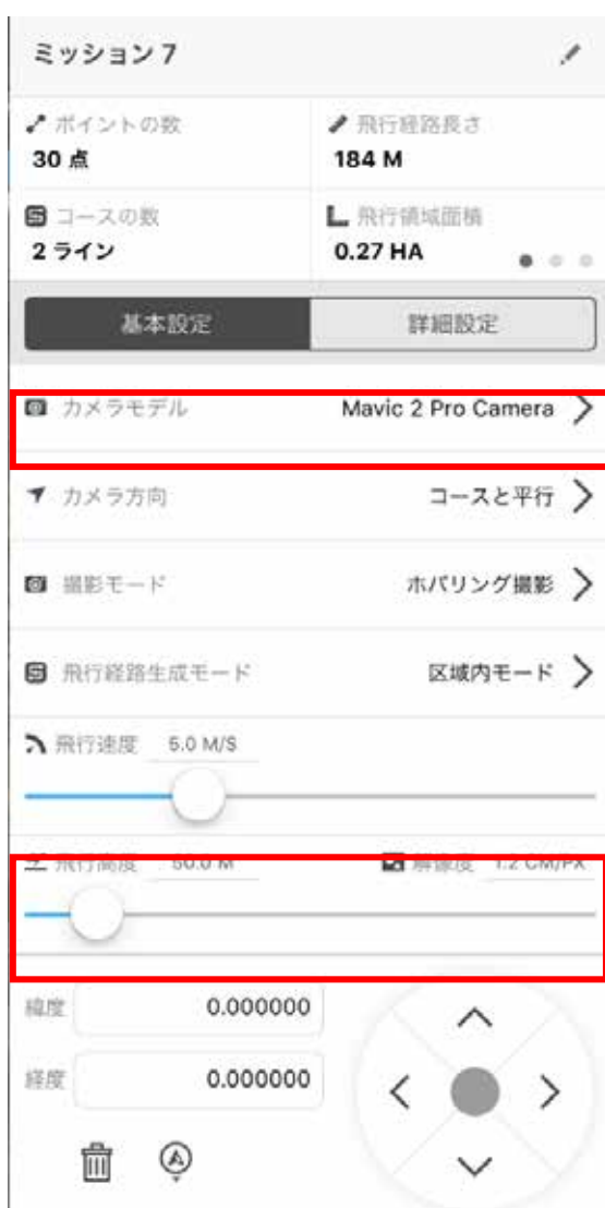
カメラモデル・飛行高度を設定し、解像度を確認
