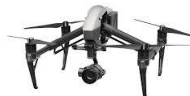
図 2-1-1 回転翼 UAV の一例。DJI 社 Inspire2、同社 Website より
