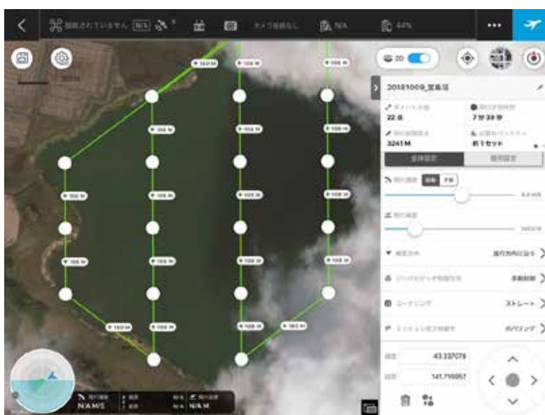
図 2-3-1 DJI GS Pro により作成した北海道宮島沼を対象とした飛行計画の例
