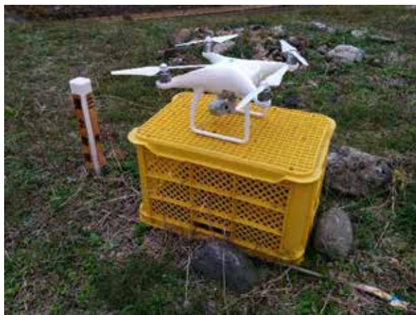
図 5-2-1 ドローンの GNSS による基準点の観測
