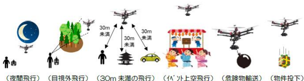
図 2-2-3 承認が必要となる飛行の方法 国土交通省航空局「無人航空機（ドローン、ラジコン機等）の安全な飛行のためのガイドライン」より
